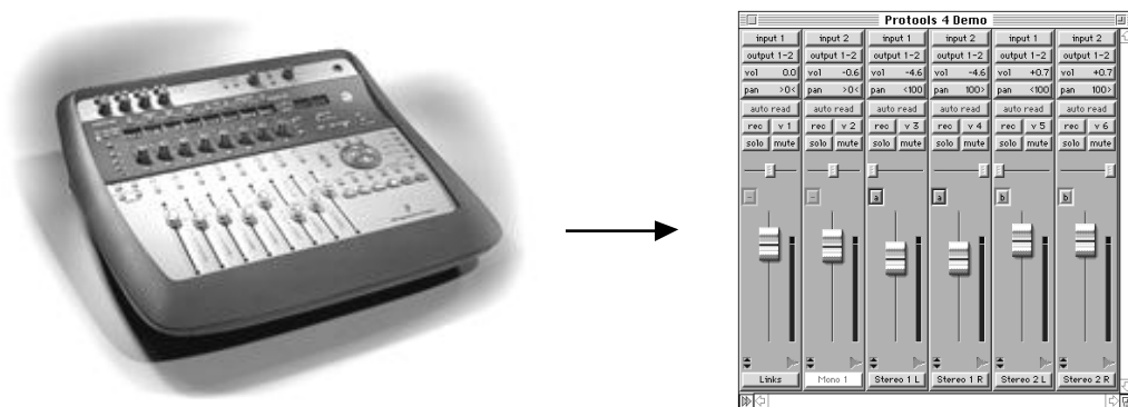
Figure 3 : Contrôleur / carte audionumérique externe Digi 002 et Interface logicielle associée (Protools). Les curseurs du périphérique externe font varier les curseurs représentés à l'écran et effectuent les traitements sonores associés. Inversement, un déplacement des curseurs situés dans le logiciel va entraîner un déplacement des curseurs réels (avec la permission de Digidesign).
